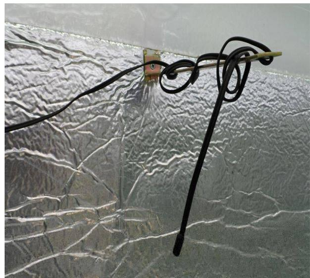
Con una staffa ho posizionato il sensore di temperatura al centro, ho poi incollato alle pareti un pannello coibentante con rivestimento in alluminio per riflettere maggiormente la luce emessa dai tubi al neon.
