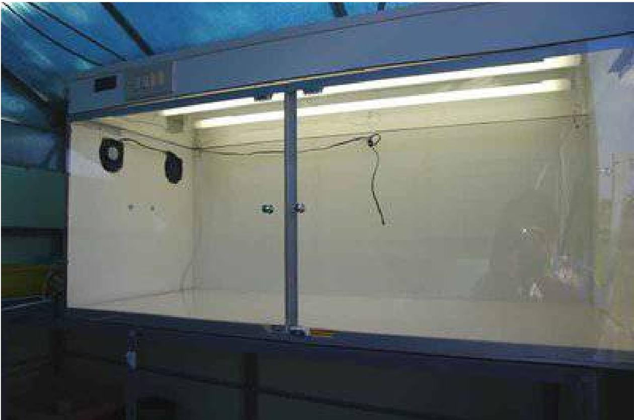
Ne è uscito un contenitore da 130 x 55 alto 55 cm, le pareti laterali, dietro ed il fondo sono fatte in legno truciolare da 2cm di spessore, sopra e le porte davanti sono in plexiglass da 3mm, ho poi costruito un secondo contenitore con misure identiche alto 12cm per mettere le luci, unito con due cerniere in modo da consentire agevolmente la manutenzione.
