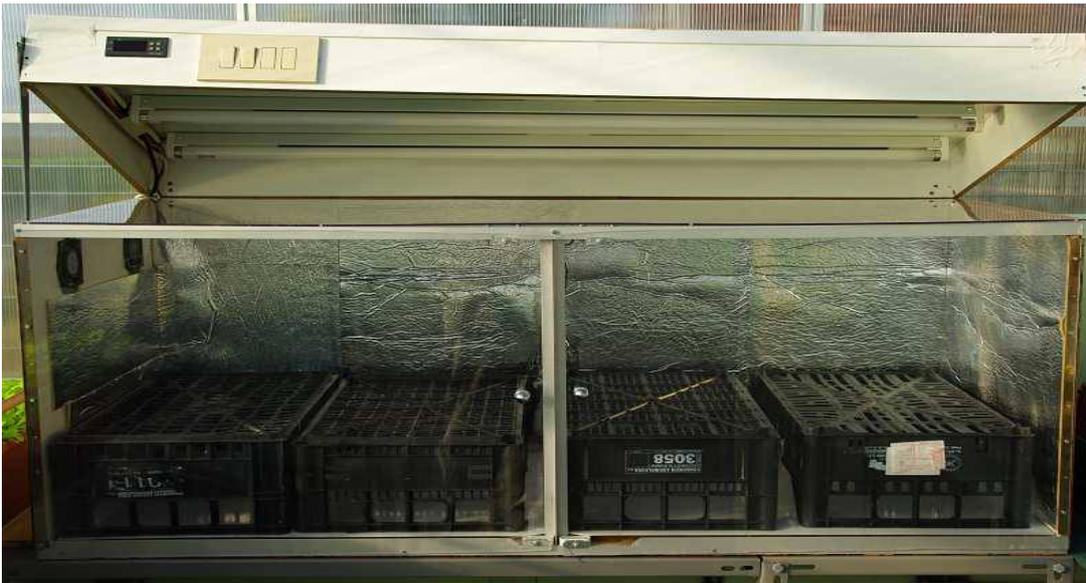
Ho inserito 5 tubi da 36W a luce fredda 6400K, ho messo sul frontale gli interruttori per l'accensione e come si vede in foto, il termoregolatore che controlla il riscaldamento, successivamente ho inserito un orologio per programmare in automatico l'accensione e lo spegnimento delle luci.
