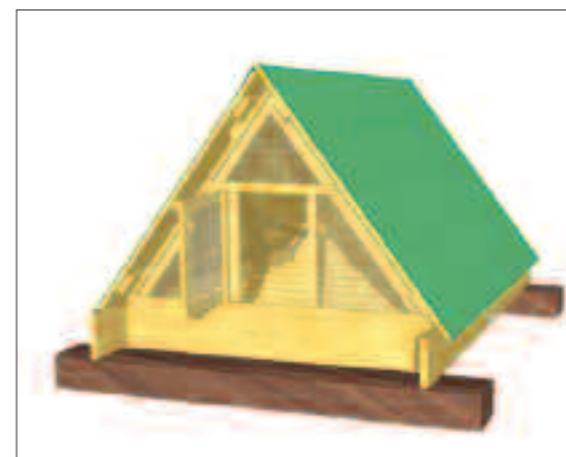
1. Vista anteriore dell'archetta montata, con le slitte appoggiate su dormienti in legno. Si noti l'impermeabilizzazione delle falde costituita da guaina colorata a protezione del tavolato sottostante
