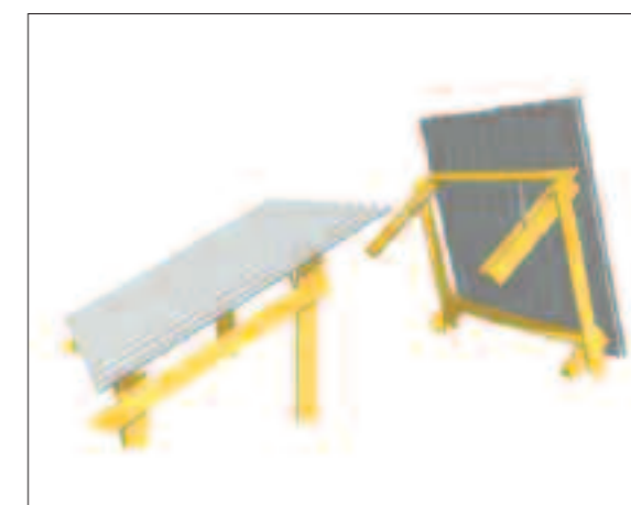
21. Data la sua leggerezza la tettoia è facilmente spostabile e può essere ribaltata in loco per le operazioni di governo
