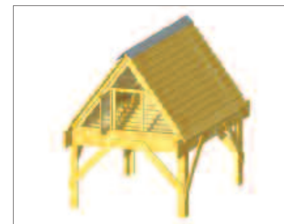
3. La stessa arca può essere impiegata nella disposizione a palafitta senza alcuna modifica, aggiungendo le zampe di sostegno. Le falde di copertura possono essere costituite da tavole embricate, senza bisogno di impermeabilizzazione
