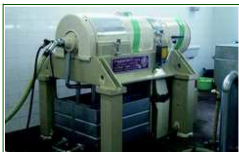
Figura 16.7 - Centrifuga ad asse orizzontale (decanter).
