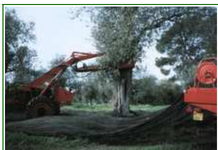
Figura 15.4 - La scuotitrice modulare in fase di aggancio dello scuotitore nella parte alta del fusto. Lateralmente è visibile l'intercettatore a bobine che provvede, dopo la vibrazione, al riavvolgimento meccanico delle reti per il trasferimento del prodotto cascolato nel cassone.
