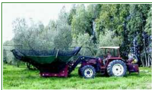
Figura 15.2 - La scuotiraccoglitrice (scuotitrice con intercettatore portato) è una macchina completa che permette, con il solo conducente, di eseguire tutte le fasi dell'operazione di raccolta delle olive dalla pianta
