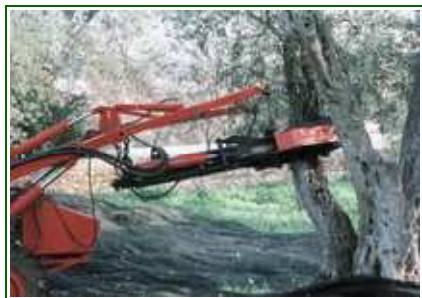
Figura 15.6 - L'adattamento e la presa della branca o del fusto da parte dello scuotitore può avvenire simultaneamente al posizionamento del telaio intercettatore sotto la chioma della pianta.
