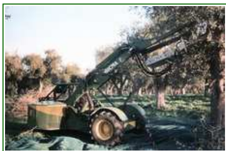
Figura 15.3 - Le scuotitrici semoventi sono costituite da un carro motorizzato e da una testa vibrante. La maggior parte di queste macchine impiega la vibrazione multidirezionale e in virtù della maggior potenza del mezzo, può operare anche su piante di rilevanti dimensioni.
